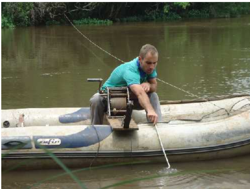
Figura 20 – Coleta de sedimentos na estação PCH Castro Montante 1, no rio Iapó, Castro/PR.
