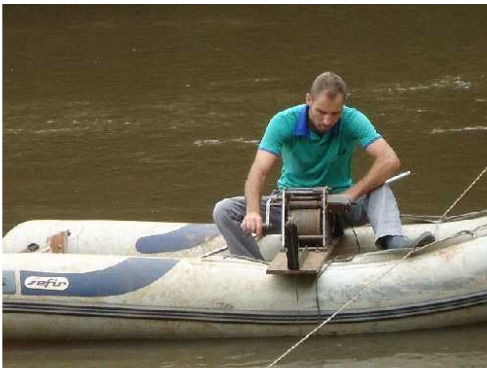
Figura 16 – Medição de vazão na estação PCH Castro Montante 2, no rio Iapó, Castro/PR.
