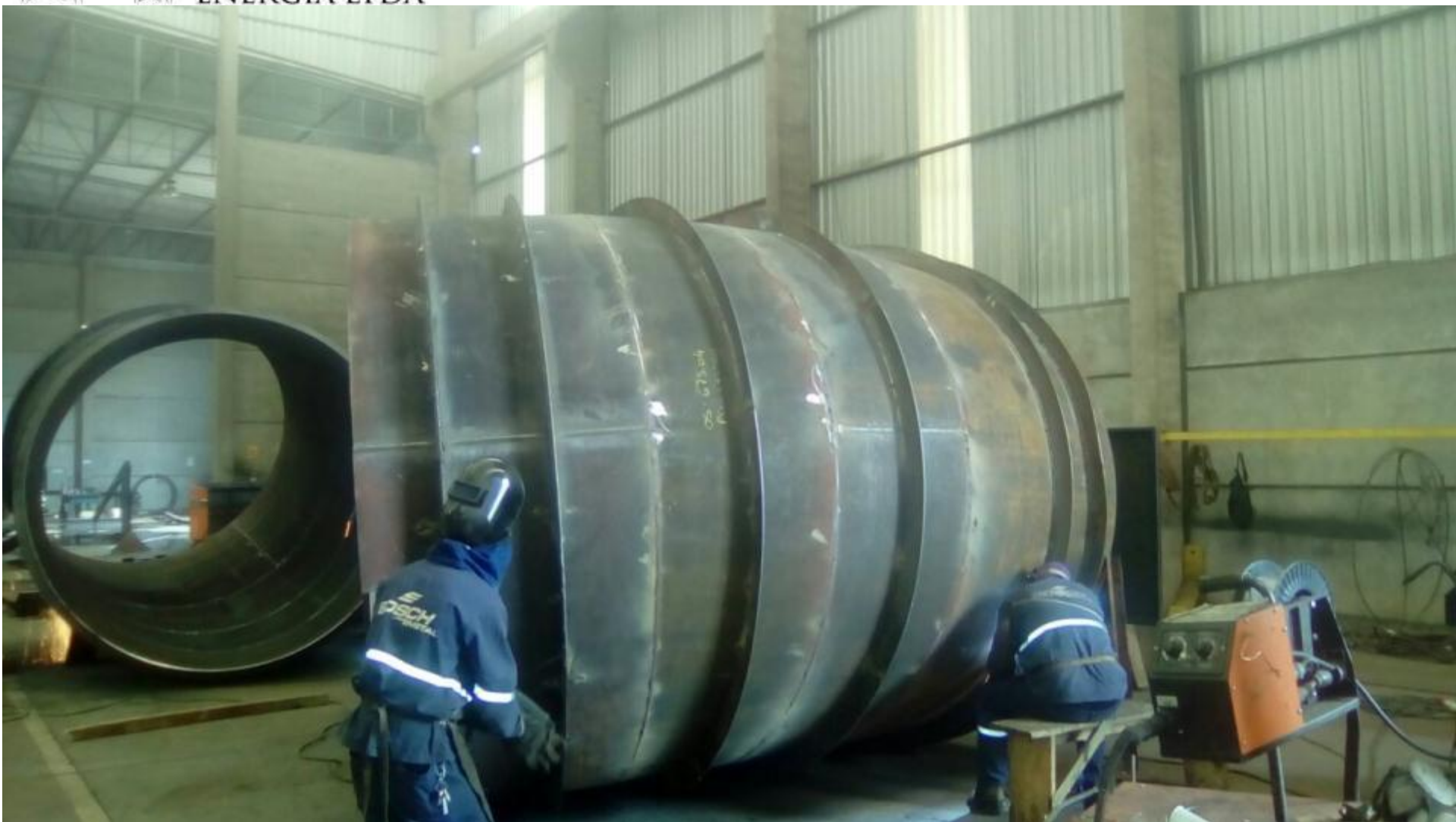
CONDUTO FORÇADO FABRICAÇÃO DAS CURVAS NA FABRICA DA BOSCH METAL
