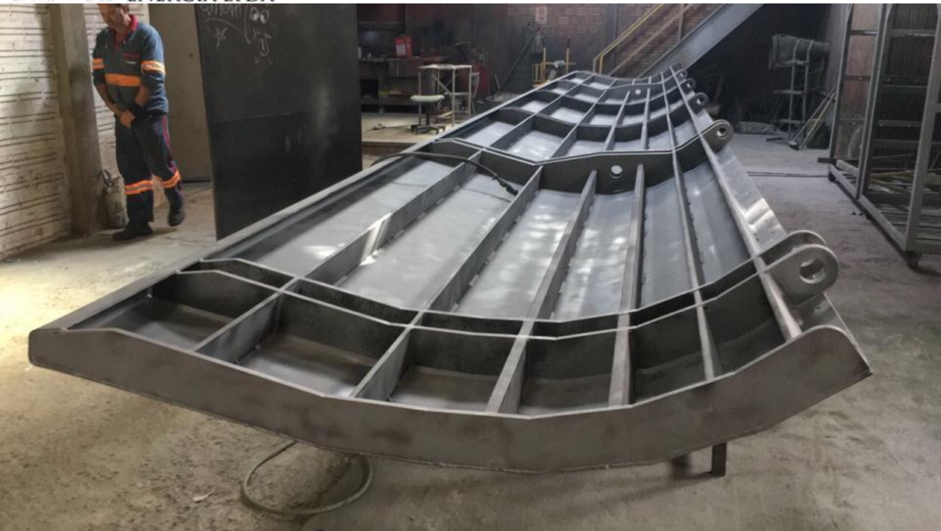
BARRAGEM VERTEDOURO COMPORTAS E FASE FINAL DE FABRICAÇÃO – PRONTAS PARA PINTURA
